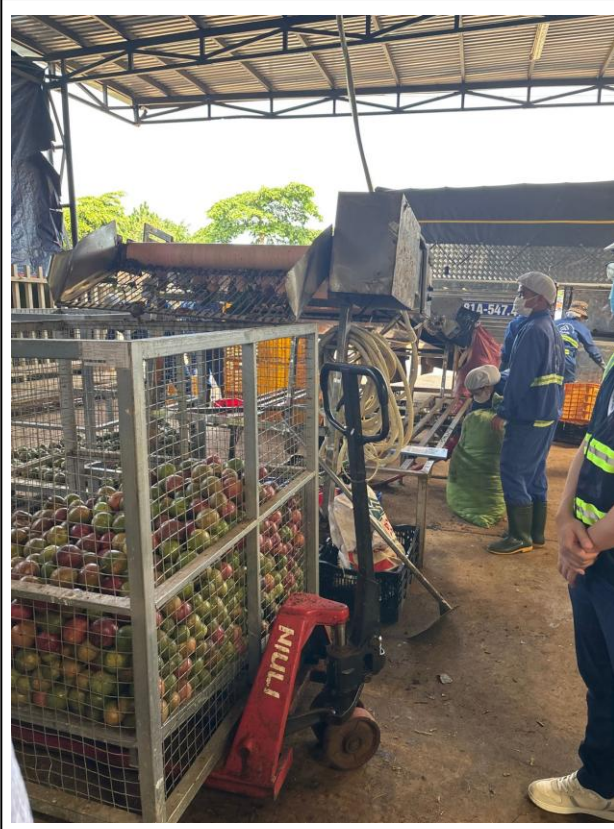
Chanh leo tươi được chở từ vùng trồng về nhà máy, sàng lọc bằng máy và đưa vào thùng chứa
