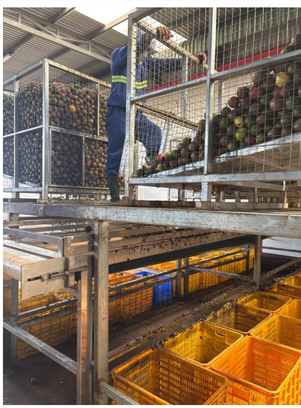
Chanh leo tươi được chở từ vùng trồng về nhà máy, sàng lọc bằng máy và đưa vào thùng chứa
